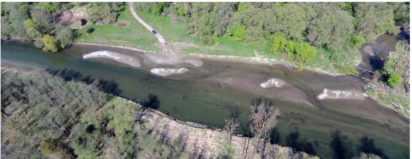
Neuanlage von Kiesbänken im Nebenfluss Rott.
